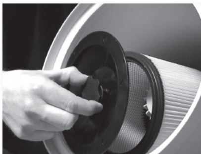
Filteret er festet med en bajonettkobling, og frigjøres ved å vri rattet mot klokken.
