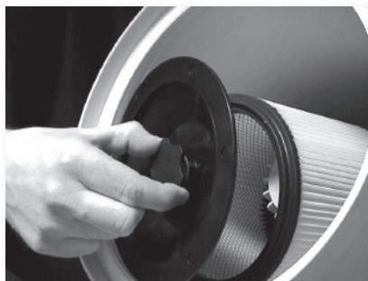
Filtret är fäst med en bajonettkoppling och lossas genom vridning moturs.
